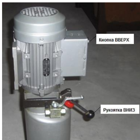
Рис. 27 Стандартное оснащение (гидравлическая станция без пульта управления)
